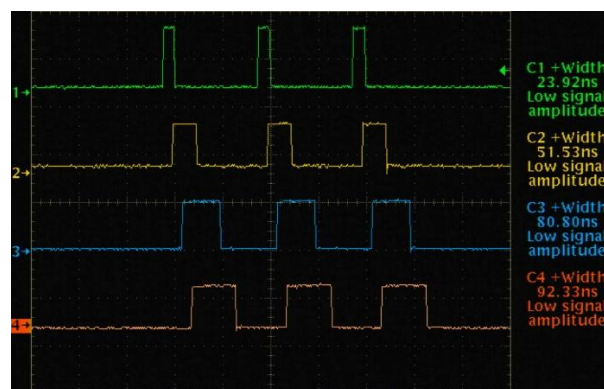
4 通道突发模式不同脉宽与延时波形
